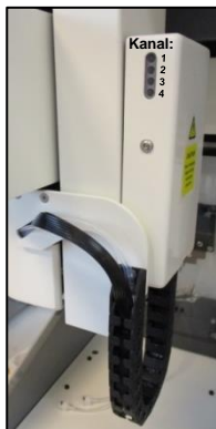
Figur 8: Pipetteringsarm med trykkovervåkingsystem.
