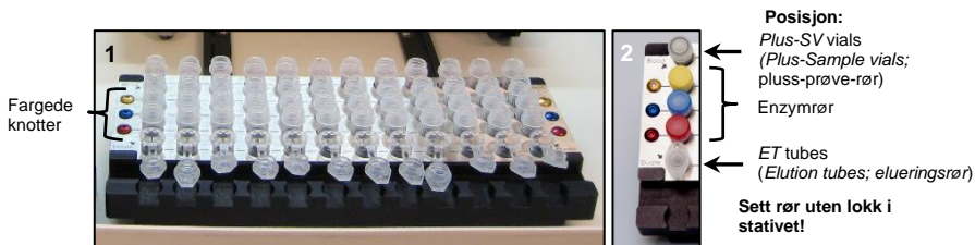
Figur 29: Reagent vial rack lastet med komponentene Plus-SV vials, enzymrør med fargekode (fargede knotter på stativet) og ET tubes (del 1).
