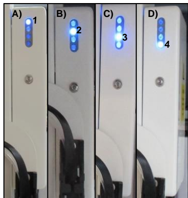
Figur 9: Fire kanaler i trykkovervåkingsystemet. Under ekstraksjonskjøringen tennes den blå LED-lampen hvis den tilsvarende prøveposisjonen på pipetteringsblokken er blokkert.
