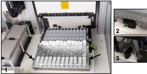
Figur 26: Prosedyre for innlasting av det fylte bufferstativet på instrumentet. Stativet er festet på begge sider med svarte klips (svarte piler, del 1). Åpen klips (del 2) og lukket klips (del 3).
